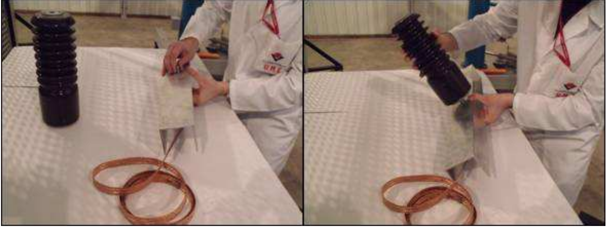
Resim EK-9.3. Mesnet izolatörünün U kesitli metale bağlantısı
