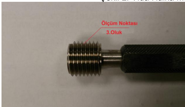
Şekil 2. Vida Halka Master ölçüm pozisyonu
