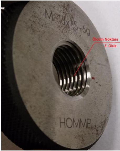
Şekil 3 M16x1,5 Vida Halka Master ölçüm noktası
