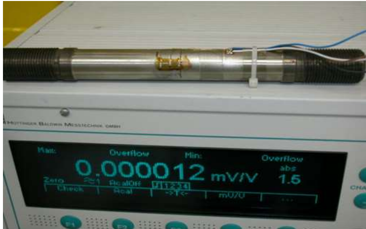
Şekil 3.8. Çekme çubuğu şeklindeki numune üzerinde dirençli uzama ölçer devresi ve gösterge ünitesi
