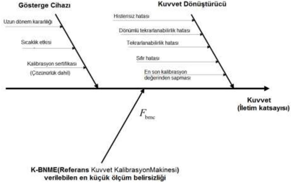
Şekil 4.12. Aynı gösterge elemanına sahip bir kuvvet ölçme cihazının ölçüm belirsizliği hesabındaki etken büyüklükler
