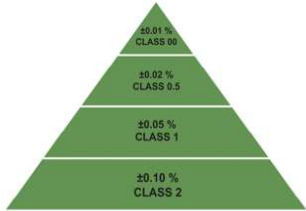
Şekil 4.5. ISO 376'a göre uygulanan kalibrasyon kuvvetinin genişletilmiş belirsizlik değerleri
