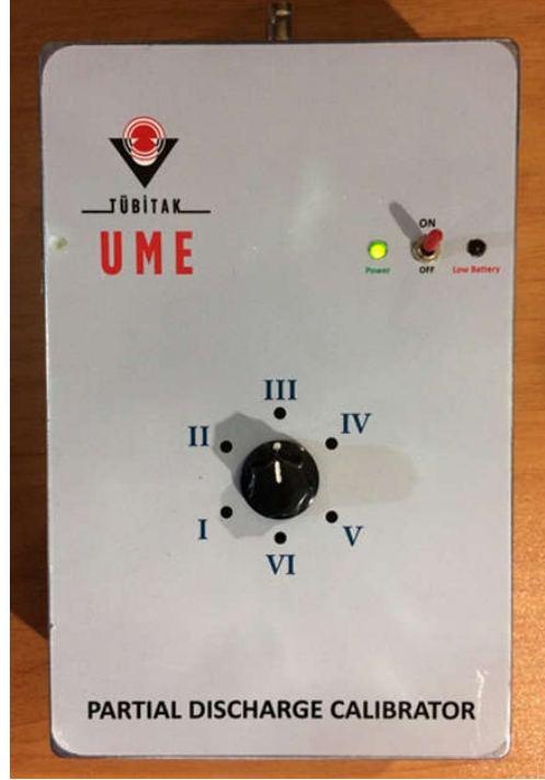
Şekil 1. Deney Numunesi (Kısmi Boşalma Kalibratörü)
