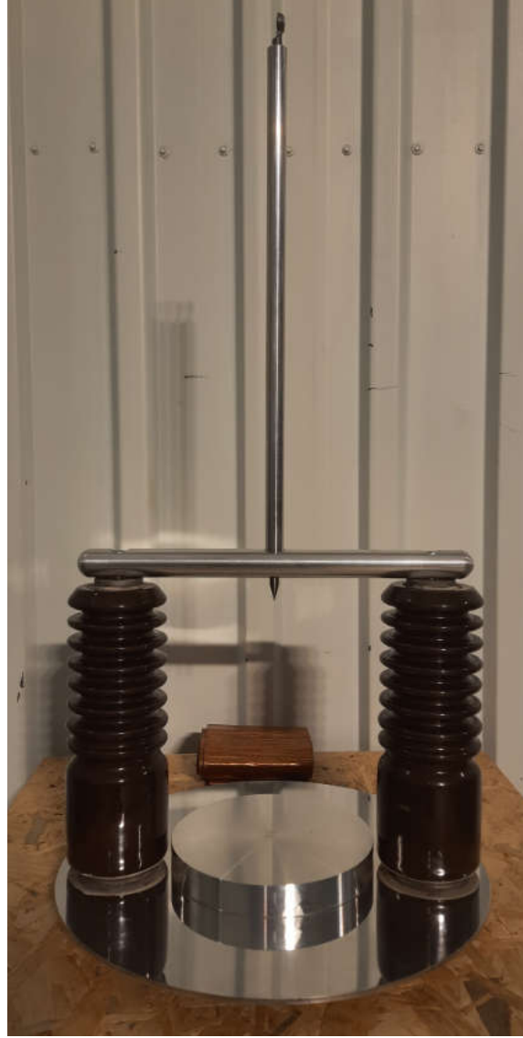
Şekil 2. Deney Numunesi (Elektrot düzeneği)
