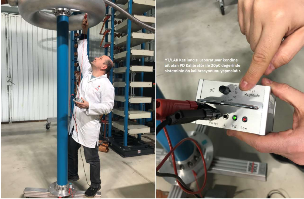
Resim EK-3.2. Öncelikle laboratuvarlar deneye başlamadan önce kendilerine ait PD kalibratörlerini ölçüm sistemlerine bağlayarak 20 pC değerinde ölçüm sistemlerinin ön kalibrasyonunu yapmaları gerekmektedir.
