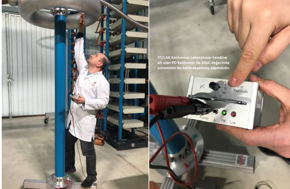
Resim EK-4.5. Bağlantılar tamamlandıktan sonra laboratuvarlar deneye başlamadan önce kendilerine ait olan PD kalibratörlerini ölçüm sistemlerine bağlayarak 20 pC değerinde ön kalibrasyon yapmaları gerekmektedir.
