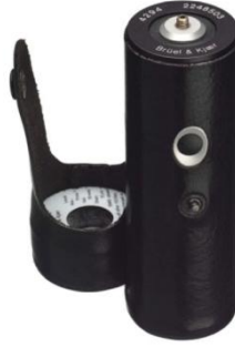
Şekil 1. Brüel & Kjaer marka 4294 Titreşim Uyarıcısı
