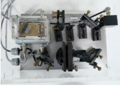
Rb atomlarını D 2 enerji geçişlerine ( \lambda=780 nm) kilitli taşınabilir ECDL sistemi
