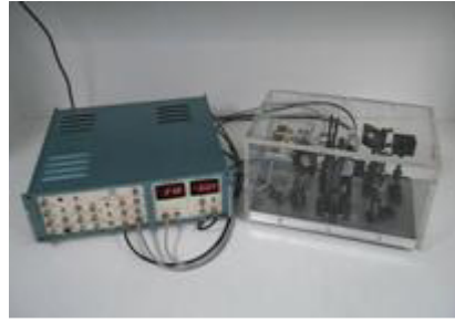
Rb atomlarını D 2 enerji geçişlerine ( \lambda=780 nm) kilitli taşınabilir ECDL sistemi
