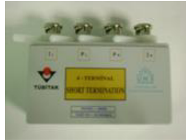
Kısa devre bağlantı adaptörü ( \leq 100 kHz)
