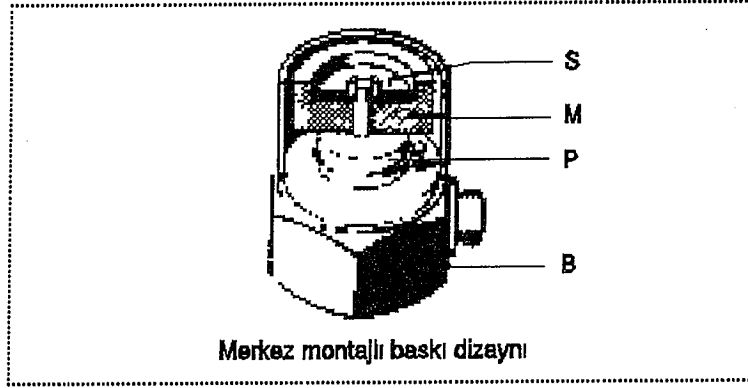
Şekil 6.9 Geleneksel sıkıştırma dizaynı
