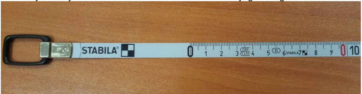
Şekil 4. Ölçüme başlama referans “0” noktası
