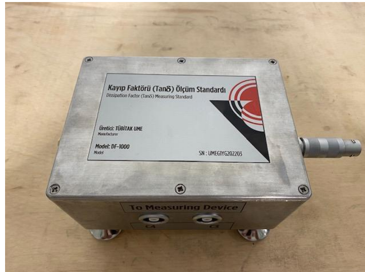
Şekil 2. Kayıp Faktörü ( \tan\delta ) Ölçüm Standardı
