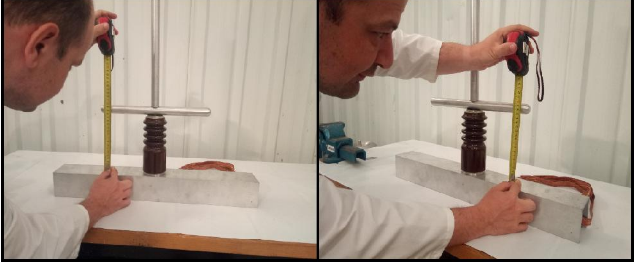
Resim EK-4.6. Paralel silindir elektrodun her iki ucunun eşit aralıkta olması gerekmektedir
