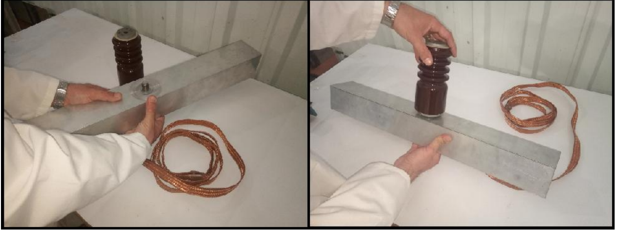
Resim EK-4.3. Mesnet izolatörünün U kesitli metale bağlantısı
